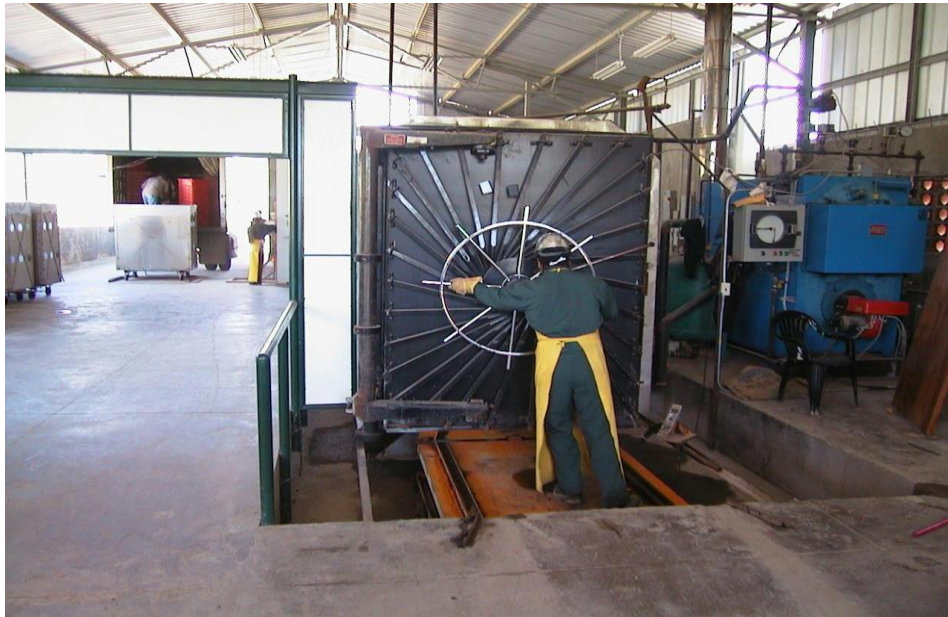
Ilustración 4 Autoclave donde son sometidos para su tratamiento los desechos bioinfecciosos de los Hospitales Nacionales.
